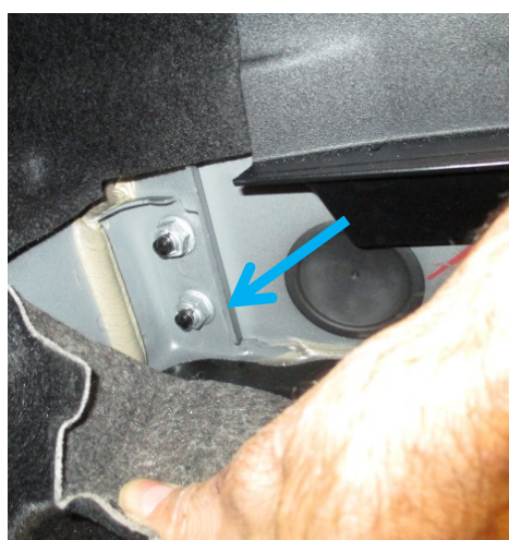
écrous hexagonaux à embase à l'intérieur du tronc
