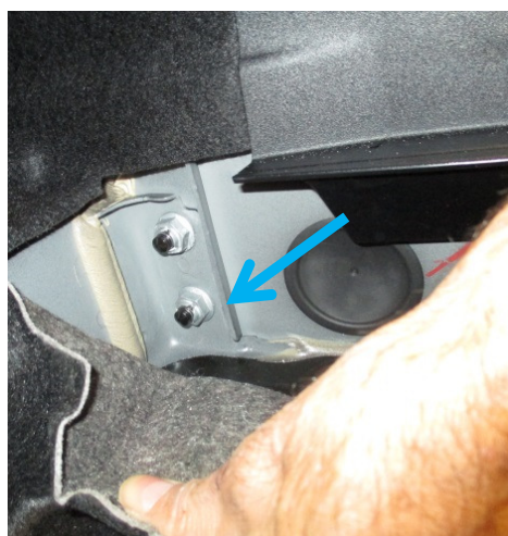
tuercas hexagonales con reborde en el interior del tronco
