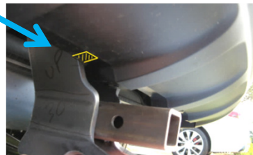
LÍNEA CENTRAL DEL PARACHOQUES Vista inferior de la fascia del parachoques
