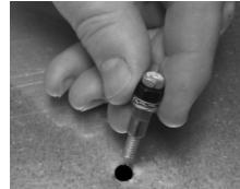
Instale los insertos Plus-nut dentro de los orificios perforados. Use una arandela de estrella nueva para instalar cada Plus-nut.
