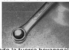
Sosteniendo la tuerca hexagonal M6 firmemente con una llave de 10 mm, apriete la tuerca hexagonal con una llave de 8 mm hasta que el inserto del Plus nut colapse (habrá un aumento de fuerza notorio).
