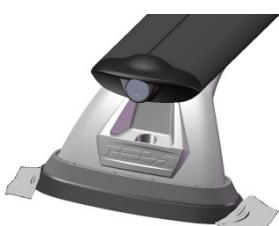
Une fois alignés correctement, fixer les adaptateurs sur la surface à l'aide de ruban adhésif. Retirer les traverses de toit avec précaution.
