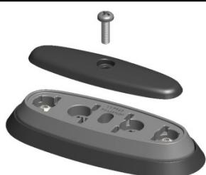
Assembler les traverses de toit à la largeur désirée et fixer les bases d'adaptateur.
