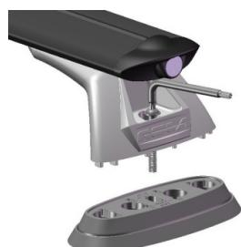
Vuelva a instalar los travesaños sobre las bases adaptadoras y apriete los tornillos en los puntos de anclaje firmemente dentro de las tuercas adaptadoras
