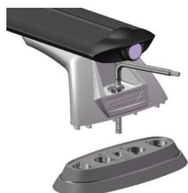
Réinstaller les traverses sur les bases d'adaptateur et serrer fermement les vis des points d'ancrage dans les écrous d'adaptateur.
