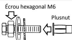
Assembler l'écrou hexagonal M6, le boulon M5 x 30 mm, la rondelle plate en acier, la rondelle en étoile et la douille Plusnut, comme illustré.
