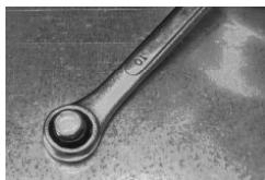
En immobilisant fermement l'écrou hexagonal M6 à l'aide d'une clé 10 mm, serrer le boulon hexagonal à l'aide d'une clé 8 mm jusqu'à ce que la douille Plusnut se comprime (on percevra une augmentation de la résistance).
